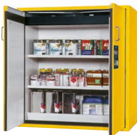
Шкаф для безопасного хранения S-CLASSIC-90 Модель S90.129.120 / S90.129.120.WDAS (с установленной системой закрытия открытых дверей) окрашен в предупреждающий желтый цвет (RAL 1004), 2 полки и нижний приемный поддон (листовая сталь, ламинированная пластиком), перфорированная вставка опционально Заказ № 30121-002-30157 (шкаф без системы закрытия открытых дверей) Заказ № 30122-002-30157 (шкаф с установленной системой закрытия открытых дверей)
